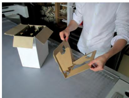
rejoignant les deux parties l'une contre l'autre. Les volets séparateurs des bouteilles vont se mettre en position au fur et à mesure du pli et de la mise en forme du produit. De même, la remise à plat est simple et ultra-rapide. Ce casier comporte de nombreux avantages :
