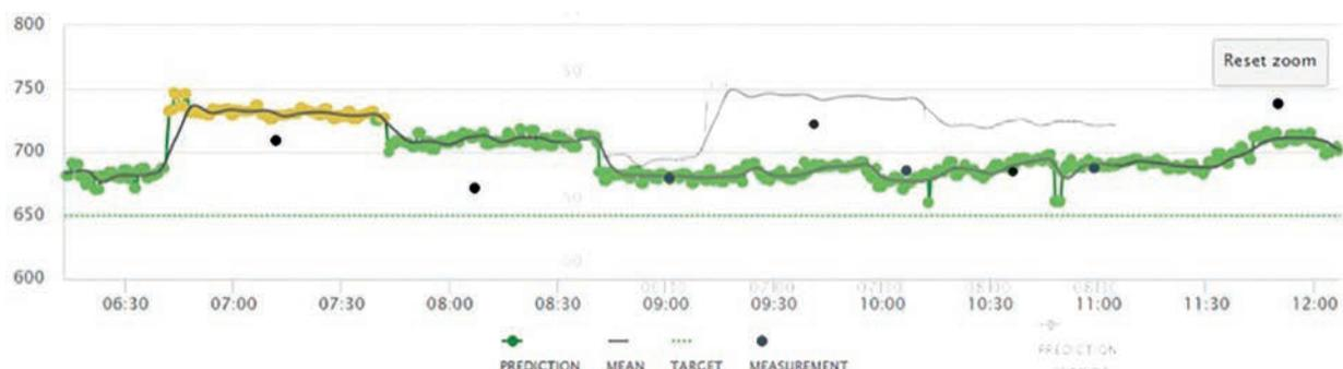
Schéma 3. Tendence de prédiction en temps réel. Les points verts et jaunes indiquent les prédictions et les points noirs indiquent les mesures réelles du laboratoire.
