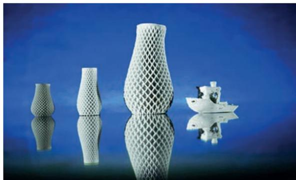
ont été déterminées. Ces résultats ont permis d'aboutir à l'impression 3D de formes complexes en matériau 100 % celluloseux avec des propriétés mécaniques comparables aux thermoplastiques habituellement utilisés en impression 3D de fils fondus.
