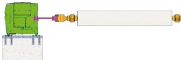
Grâce au partenariat avec la société ACOEM experte en intelligence artificielle depuis 40 ans, ALLIMAND a mis au point **le Monitoring d'une tête de branlement**. L'objectif est de prédire dans un premier temps le remplacement des pièces d'usures par identification de **symptômes vibratoires caractéristiques**.
